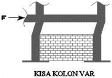
Şekil 7: Kısa Kolon Etkisi
