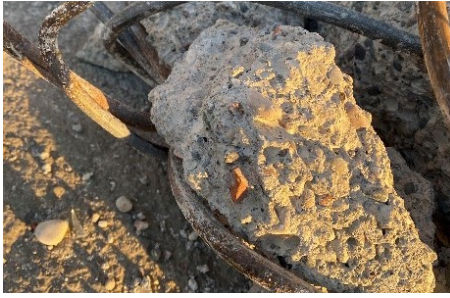
15a: beton-donatı aderansı
