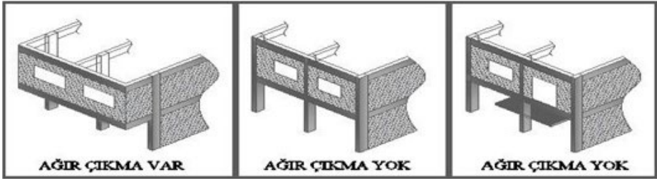
Şekil 8: Ağır Çıkmanın Temsili Gösterimi
