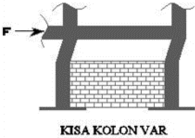
Şekil 7: Kısa Kolon Etkisi
