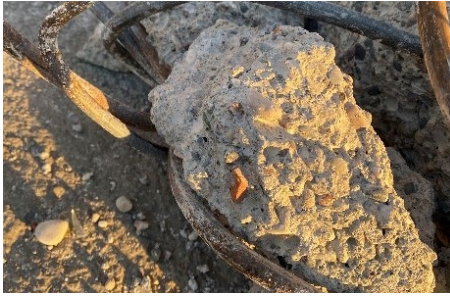
15a: beton-donatı aderansı
