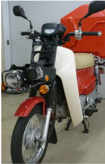
Fotoğraf 26: Proje Kapsamında Posta Kuryesi Motosikletine Takılan Kamera ve Dedektör 175
